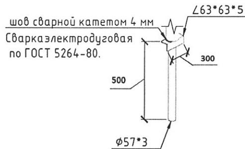
Рис. Крепление на металлические закладные
